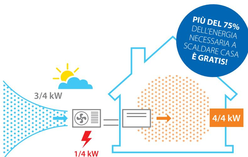
**Il loro principio di funzionamento è molto semplice:** tramite il fluido refrigerante, **trasferiscono il calore da un ambiente, l'aria esterna, a un altro**, la stanza che vogliamo **riscaldare** (oppure viceversa, se vogliamo **raffrescare**). Il climatizzatore in Pompa di Calore non genera quindi calore dalla combustione, come fanno ad esempio le caldaie a gas o le stufe a pellet, ma consuma solo l'energia elettrica necessaria a trasferire il calore naturalmente presente nell'aria.
